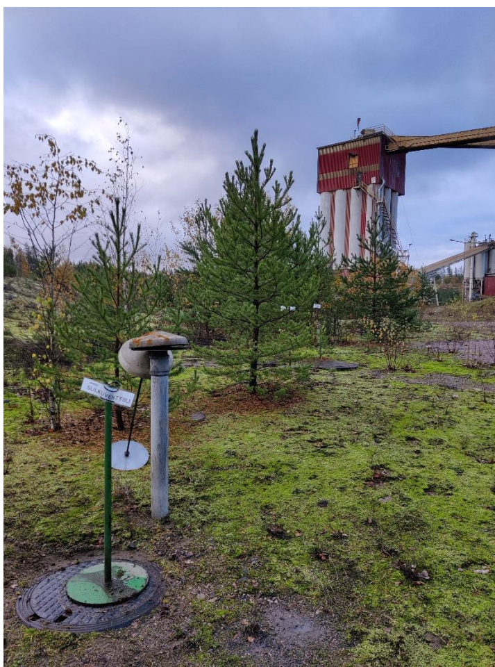
Kuva 2. Hulevesijärjestelmän näytteenottokaivo, kuva 12.10.2023.
