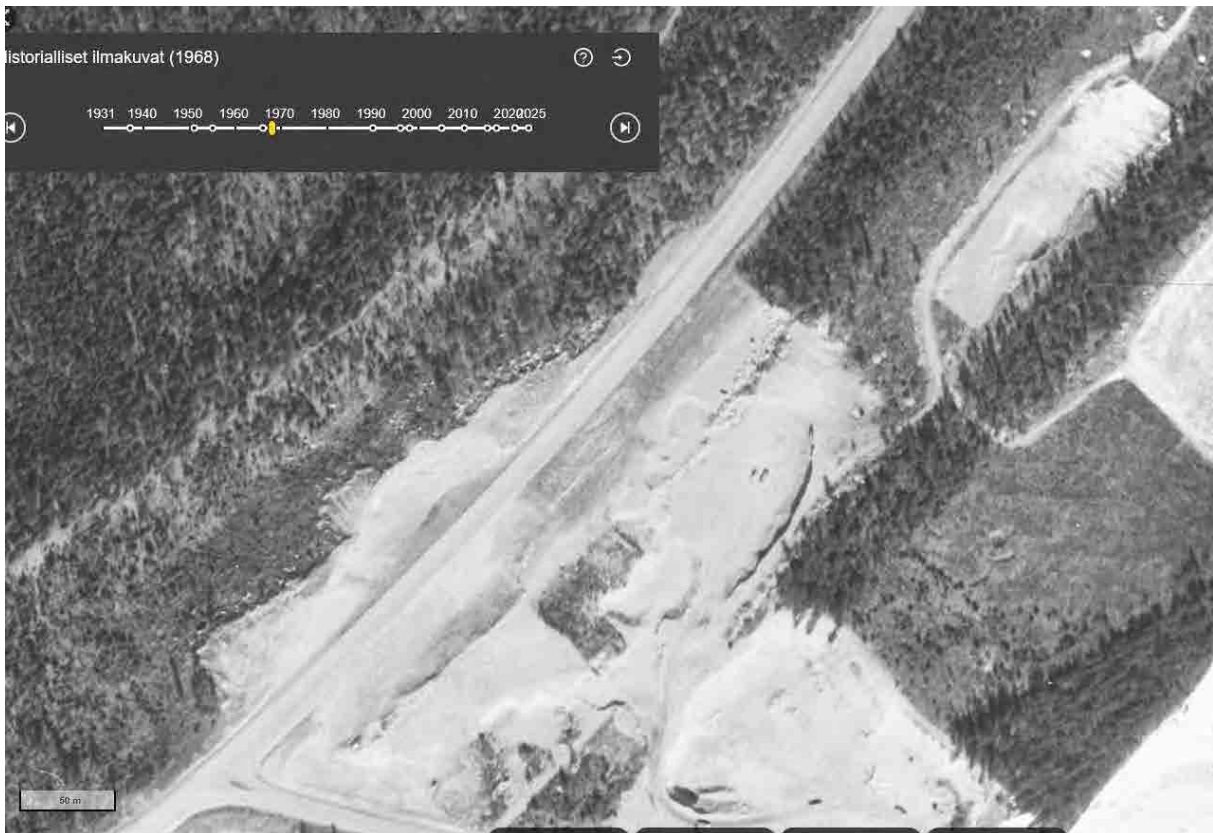
Kuva 4. Sama kohta kaksi vuotta myöhemmin. Tie 25 sekä alakulmassa siitä haarautuva Asemantie ovat valmis-tuneet. Valumat alarinteeseen ovat tässä tarkassa kuvassa edellistä kuvaa selkeämpiä. Ilmakuva Paikkatietoik-kunasta.
