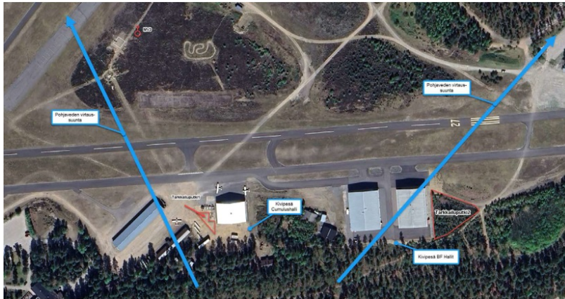
Kuva 2. Tarkkailuputkien sijainnit ja pohjaveden virtaussuunta.
