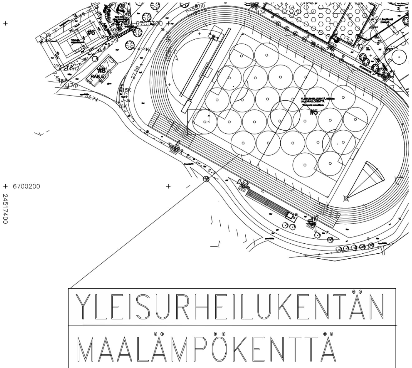
Kuva 12. Maalämpövaihtoehdon 2 yleisurheilukentän maalämpökaivokentän luonnos.
