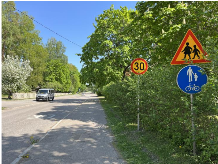
Kuva 1. Hannankadun kapea yhdistetty jalankulku- ja pyörätie, joka on erotettu ajoradasta reunakivellä.
