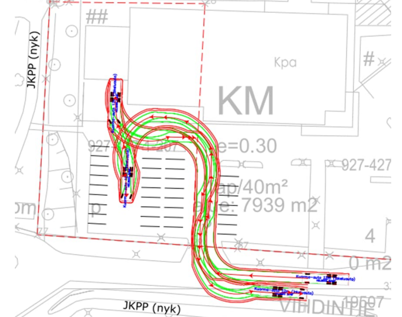
Kaksi pysäköintipaikkaa poistamalla ja saareketta siirtämällä huoltoajo mahtuisi ajamaan ilman peruuttamista.
