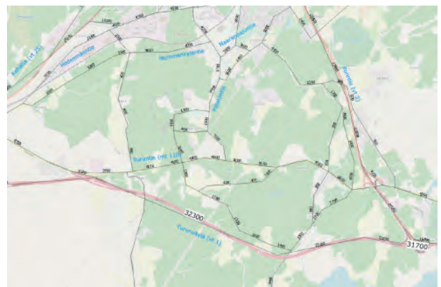
Kuvassa on esitetty iltahuipputunnin liikenneennusteen perusteella lasketut keskiarvivuorokauden liikennemäärät v. 2050 suunnittelualueella (molemmat suunnat yhteensä) verkolla, jossa mt 110 nopeusrajoitus nykyisellään 80 km/h Ramboll Finland Oy, 2021.
