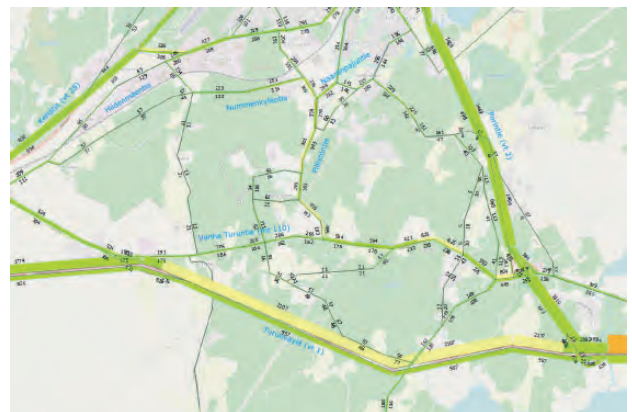
Kuvassa on esitetty ennustevuoden 2050 iltahuippuputunnin liikennemäärät suunnittelualueella (molemmat suunnat erikseen) verkolla jossa mt 110 nopeusrajoitus nykyisellään 80 km/h. Ramboll Finland Oy, 2021.
