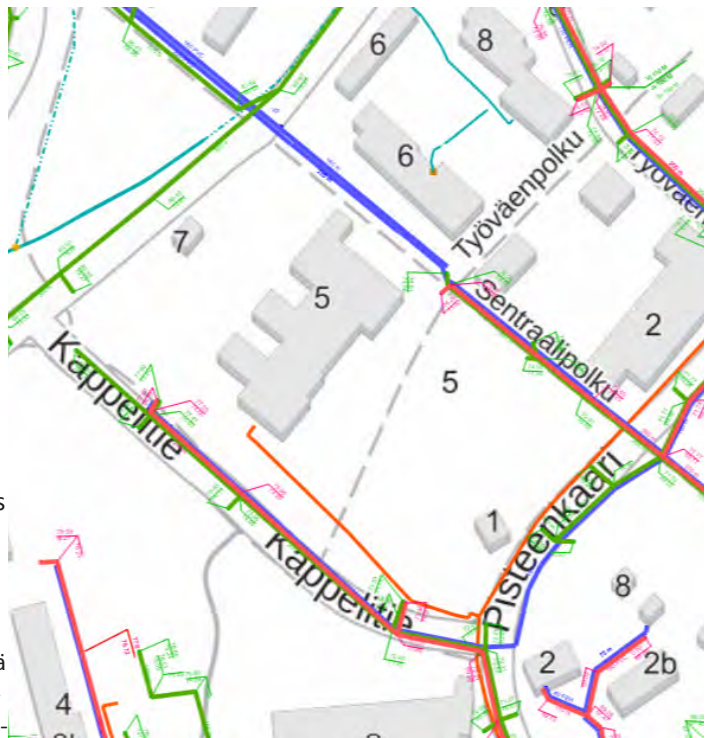
Suunnittelualueen kunnallisteknistä verkostoa. Kuvassa punaisella myös kaukolämmön linjaukset korttelialueella, joka on todennäköisesti linjattava uudelleen kaavan toteuttamisen mahdollistamiseksi.
